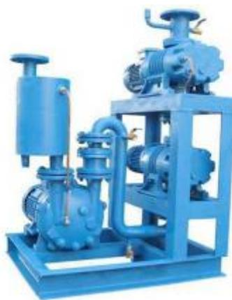
真空机组的使用在化工生产中是比较常见的，它可以实现对容器抽送气体的效果，在实际的生产中机组的性能与机组中前级泵、罗茨泵和其它泵都有密切的联系，然而不同的泵之间是怎样的联系呢？接下来一起来看一下它们之间的性能关系。1、由于罗茨泵的转子与转子之间、转子与壳体之间存在着间隙，因此有返流存在，而这种返流受进口压力和出口压力的影响，即使是同一台罗茨泵，使用不同的前级泵时，其抽气速率也会有所不同。罗茨泵的抽气速率可由下式确
