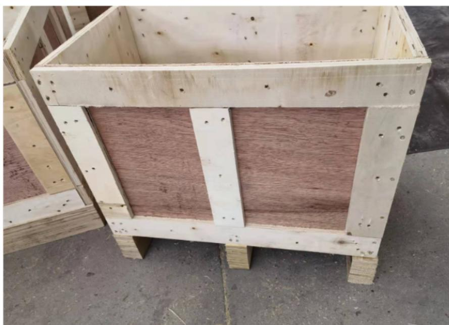
木箱包装运输是用包装箱的标志要求收发货标志符合规定，包装、储存、运输的图形标志符合规定。标志应牢固清晰，不得因运输和自然条件的影响而褪色或脱落。组装包装要求为了便于装载、卸载、储存和运输，将几个产品包装在一起形成合适的处理单元。集装箱运输木箱的外形尺寸应按规定设计，夹板运输木箱的外形尺寸应符合规定。运输要求应严格按照包装箱上的标记和编号进行。包装好的木箱应堆放整齐牢固，放置平衡。不允许装运易燃、易爆和易腐蚀的物品。应满足储存要求。木箱包装的存放环境应通风良好。包装好的木箱保护货物的完整性，具有很强的防撞能力、很强的抗挤压能力、坚固性、很强的承载能力和美观的外观，避免运输过程中的损坏和防雨。木箱包装安全又环保。上海出口木箱熏蒸供应商
